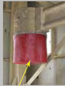
▲ Der PUCEST ® Auslaufschlauch: Bei dieser Mischanlage wurde am Schwenkarm für Selbstabholer ebenfalls ein PUCEST ® Auslaufschlauch angebracht
