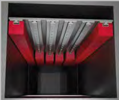
4. Die verschlissenen Modul-Bausteine werden herausgenommen...
