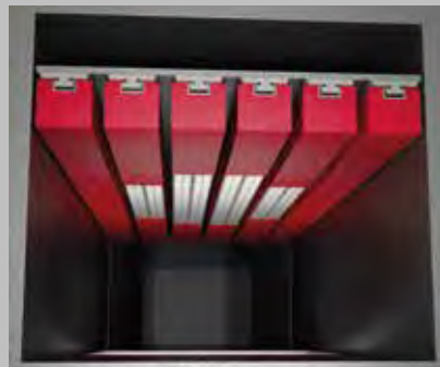
6. Die neuen Hartmetall Modul-Bausteine sind eingebaut
